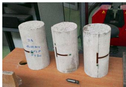
Rys. 2. Próbkę walcową z naklejonymi tensometrami
