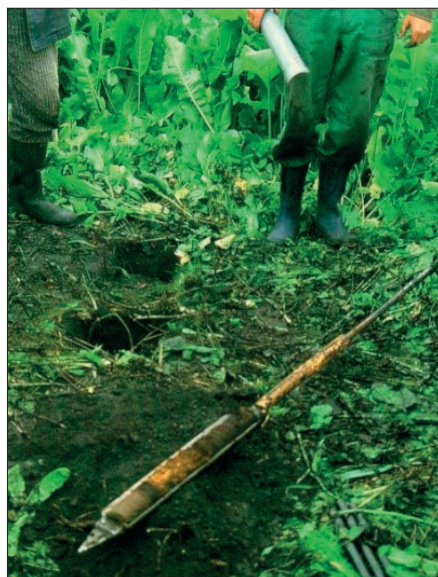
Fot. 7. Wiercenie ręcznym – komorowym świdrem (średnica 5 cm) w torfie na Ostrowie Lednickim (fot. K. Tobolski)
