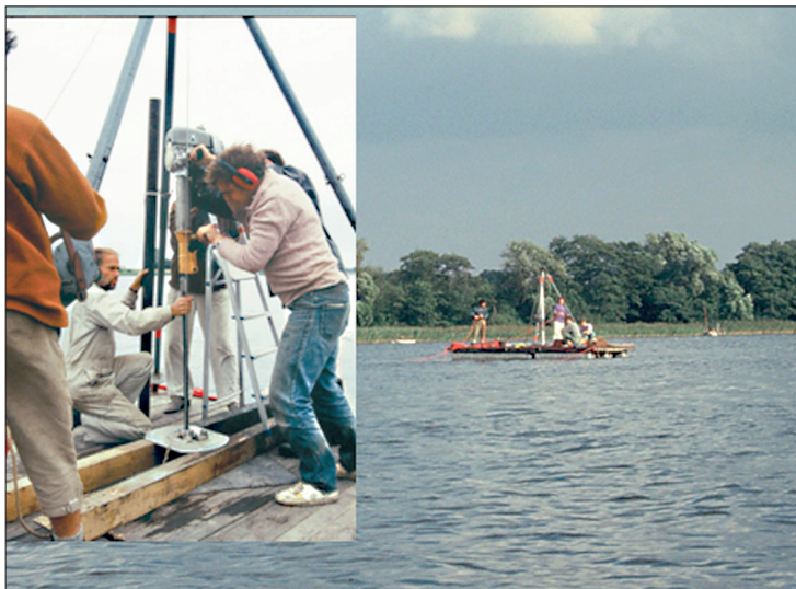
Fot. 3. Podwodne wiercenie w jeziorze Lednica (na zachód od wyspy Ostrów Lednicki) sprzętem Instytutu Archeologii Uniwersytetu w Kilonii (wówczas najlepszy w Europie), konstrukcji prof. dr. H. Usingera (konstruktor w białym kombinezonie po lewej stronie). W tle Jezioro Lednickie (na wschód od Ostrowa Lednickiego) i ponton z wiertnią (fot. K. Tobolski)
