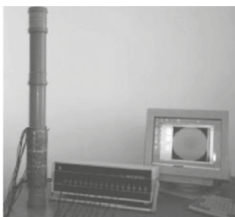
Rys. 6. Silos laboratoryjny, wyposażony w dwupłaszczyznowy (dwa przekroje oddalone od siebie o 100mm) czujnik pojemnościowy i elektryczny tomograf pojemnościowy, na stanowisku badawczym (zespół tomoKIS)
